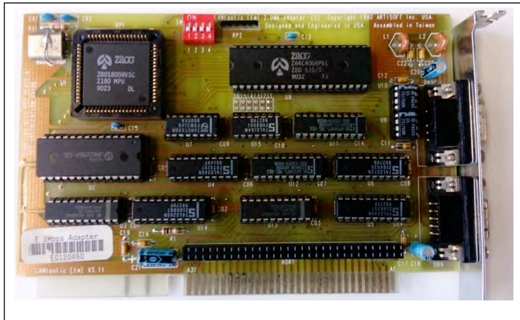
Fig. IV.8. Tarjeta de red LANTASTIC de 1990 conector AUI.
