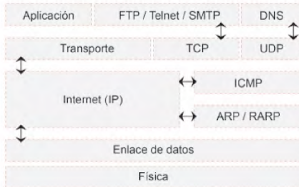
Fig. IV.32. Protocolos de capa 4 interactuando con capas 3 y 5, vía los protocolos TCP y UDP.
