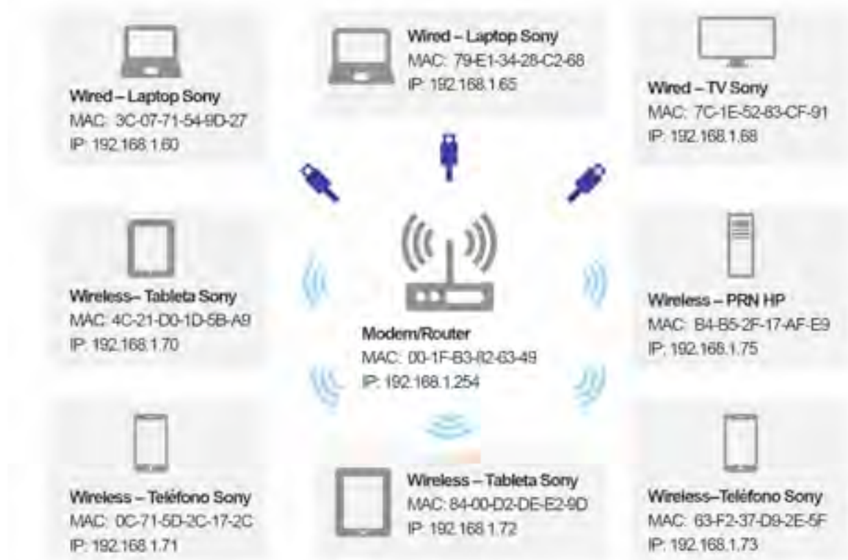
Fig. IV.18 Ejemplo de topología de una red casera en la que conviven los estándares IEEE 802.3 e IEEE 802.11.
