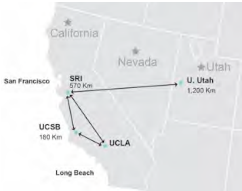
Fig. III.1 Topología del backbone de ARPANET en diciembre de 1969 en los EUA.
