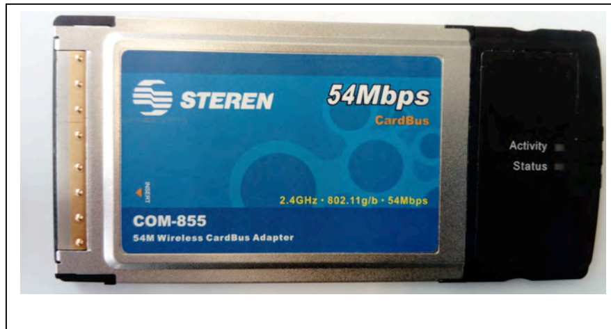
Fig. IV.9 Tarjeta de red WNIC externa tipo “CardBus” PCMCIA 5.0 de 32 bits de 1998, máximo 54Mbps.
